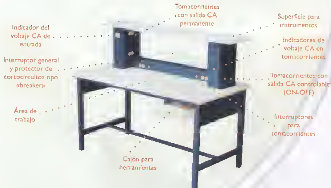
Figura 9.15. Banco de trabajo CEKIT con funciones propias para electrónica
